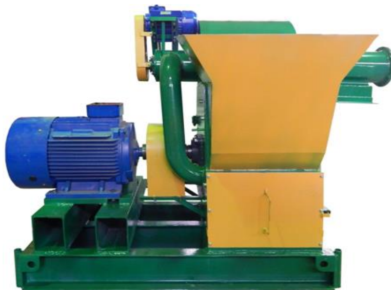
1.8 сурет - Автоматты "Хайдрокоун-436" ұсақтағышы
