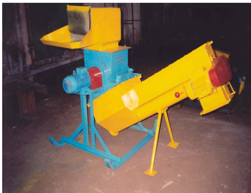
1.3 сурет-АКМ-5,5 жем-шөп дайындау агрегаты
